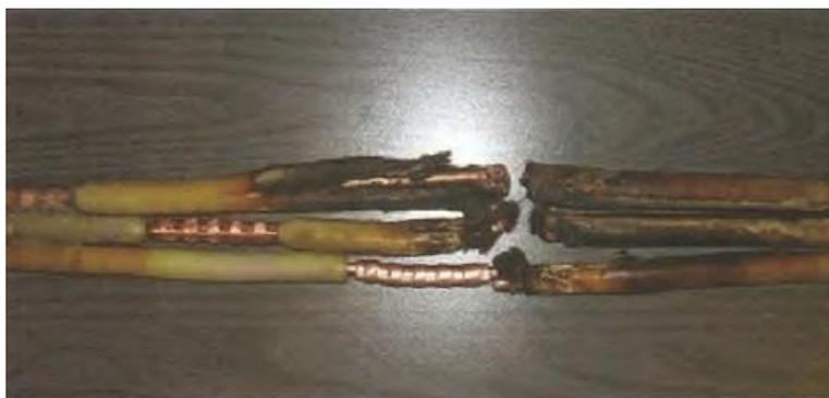
Рисунок 17 – Прогар в месте сродки погружного кабеля
