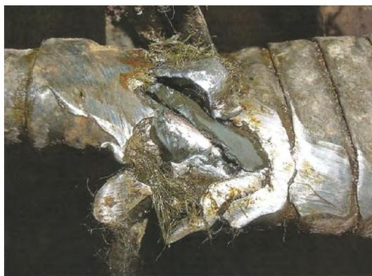
Рисунок 20 - Перекручивание кабеля
