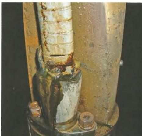
Рисунок 18 – Негерметичность системы в результате перегрева
