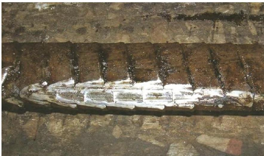
Рисунок 19 – Прогар на месте механического повреждения
