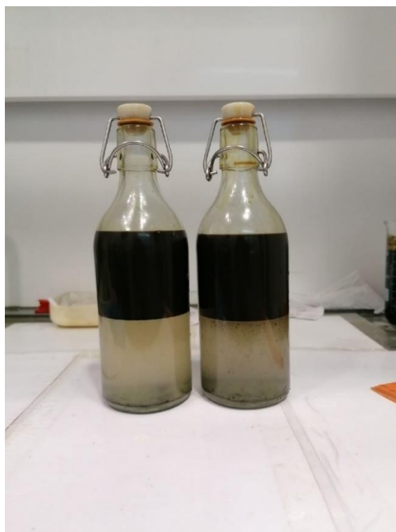
Рисунок 11 – Образец пробы нефти с обработанными двумя деэмульгаторами
