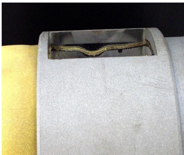
**Рис.5.25** Соединение с существующей трубой
