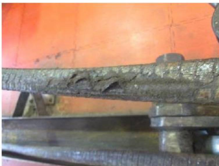
Рисунок 1.3 – Коррозия брони кабельной линии
