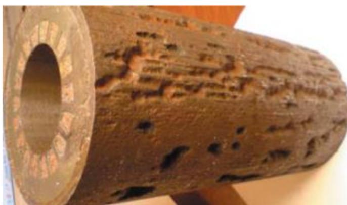
Рисунок 1.1 – Коррозия корпуса погружного электродвигателя
