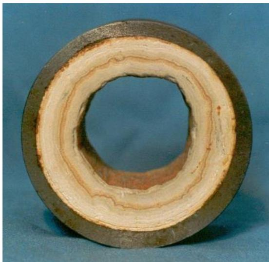
Рисунок 1.7 – Отложения  $BaSO_4$  в насосно-компрессорных трубах
