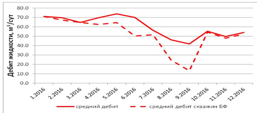
Рисунок 2.7 - Характеристика работы фонда скважин: средний дебит жидкости
