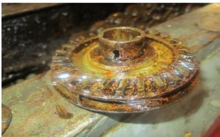
Рисунок 1.4 – Рабочая ступень ЭЦНАКИ5-80-2434 на комиссионном демонтаже погружного оборудования
