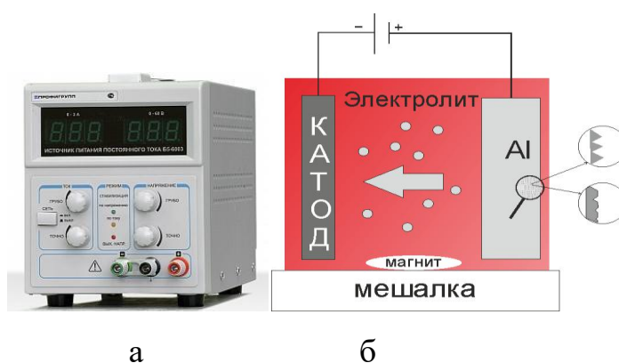
Рисунок 2.1. Установка электрохимической полировки; а) источник питания ИПТ «Профигрупп» б) схема установки полирования
