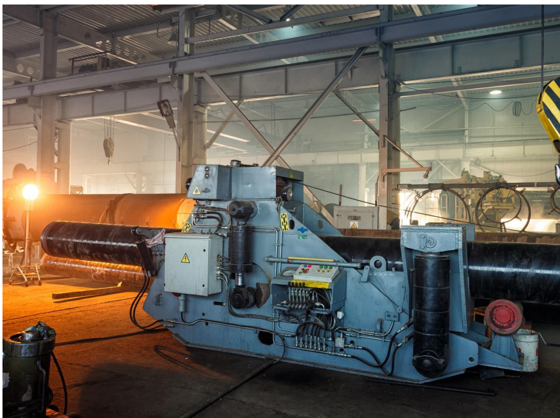
Рис. 5 – Производство отводов холодного гнутья
