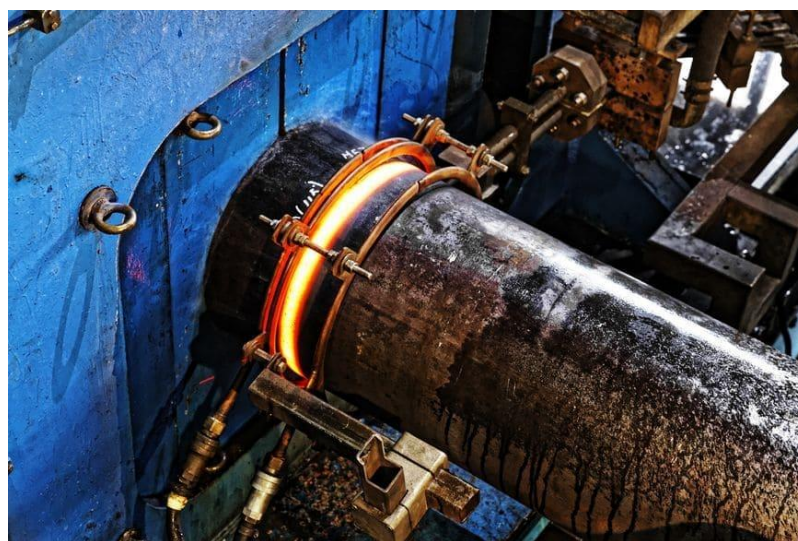
Рис. 3 – Производство горячегнутых отводов
