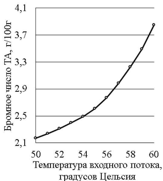
Рис. 9. Зависимость бромного числа ТА от температуры входного потока
