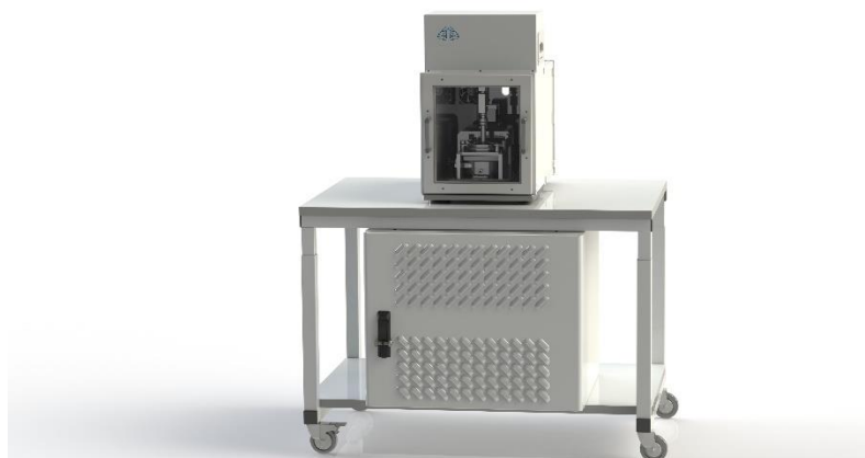
Рисунок 9 - Прибор одноплоскостного среза для испытания мерзлых грунтов автоматизированный ГТ 1.2.14 [82].
