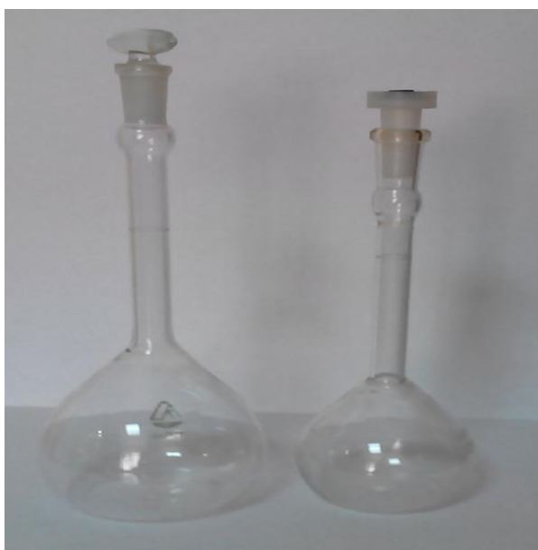
Рисунок 7 - Пикнометр для определения плотности частиц грунта [78].
