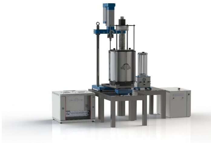
Рисунок 10 - Автоматизированный испытательный комплекс АСИС с комплектом оборудования для испытаний образцов мерзлых грунтов методом одноосного сжатия [83].
