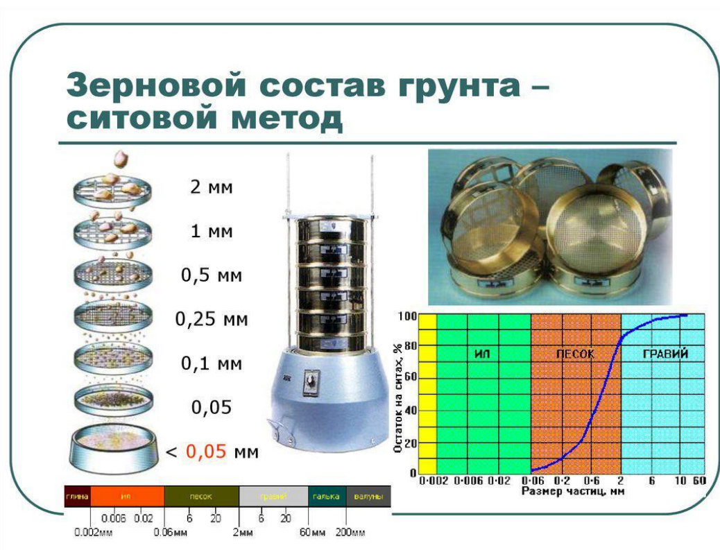
Рисунок 4 - Ситовый метод определения гранулометрического состава [79].
