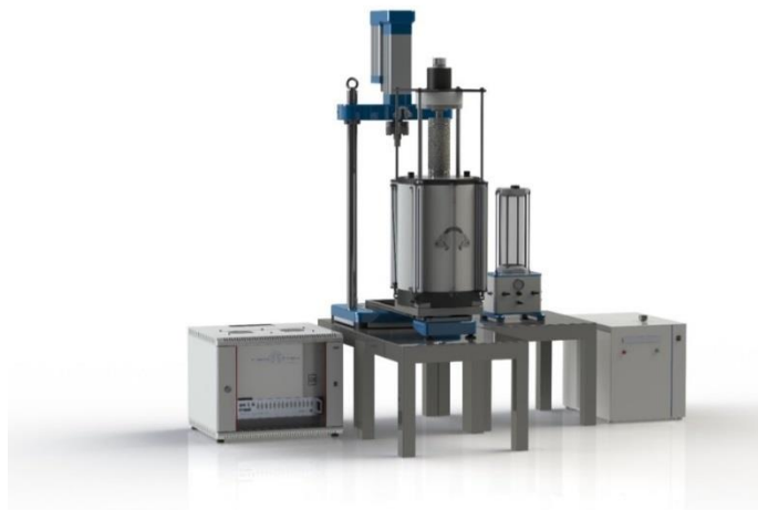
Рисунок 12 - АСИС Про для испытания мерзлых грунтов методом одноосного сжатия [96].
