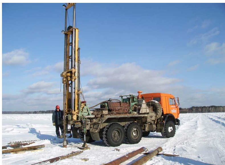
Рисунок 8 – Буровая установка ПБУ-2 на базе автомобиля «КАМАЗ»
