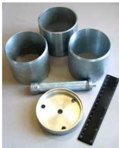
Рисунок 3.11 Кольца режущие ПГ-400 (комплект) предназначены для отбора проб грунта при определении плотности не мерзлых пылевато-глинистых грунтов [84].
