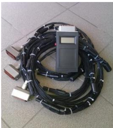
Рисунок 3.7 Прибор для измерения и отображения температуры грунтов, ЭТЦ-0,1/10 термомока с датчиками ТК-15/11 [82].
