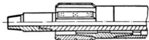
Рисунок 18 – Ниппельный центратор забойного двигателя
