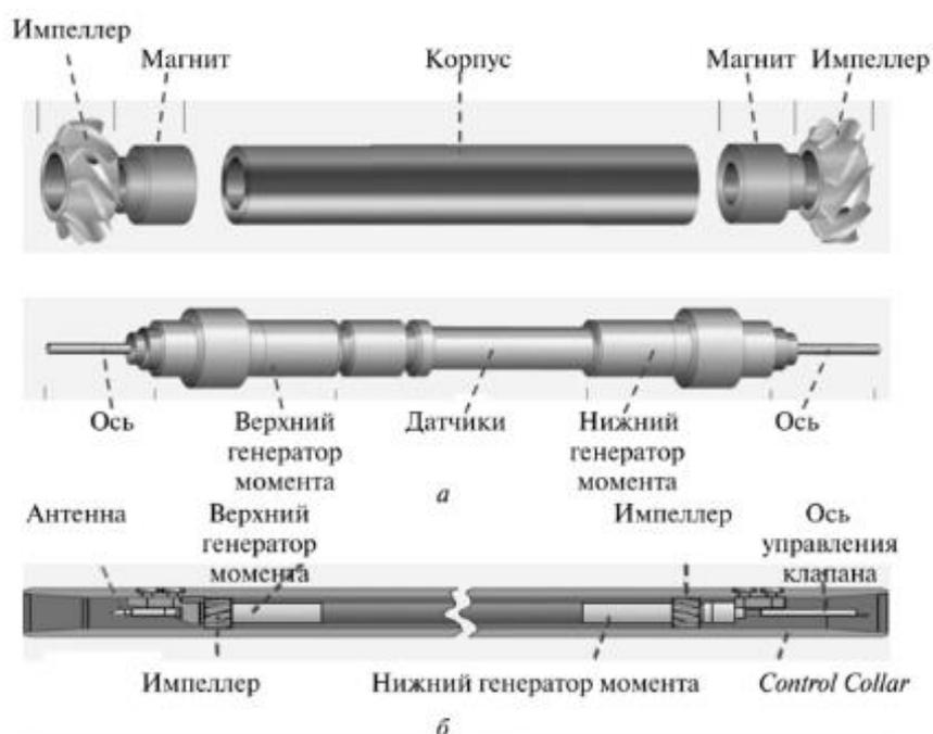
Рисунок 29 – Энергетический блок и электронный блок управления
