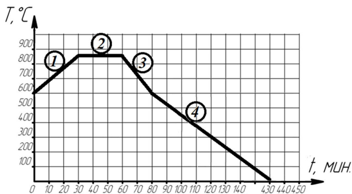
Рисунок 1 – Температурно-временной режим производства пеностекла: 1 – нагрев; 2 – вспенивание; 3 – резкое охлаждение (фиксация структуры); 4 – медленное охлаждение (отжиг)
