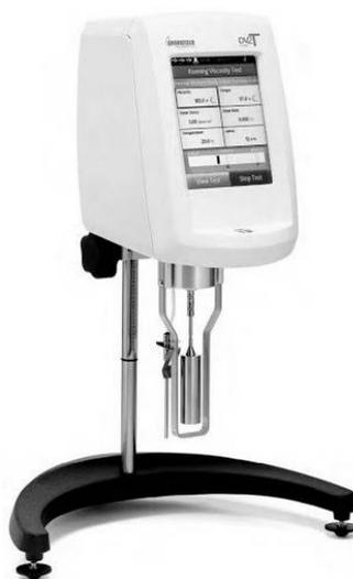
Рисунок 2.17 – Ротационный вискозиметр Брукфильда DV-II
