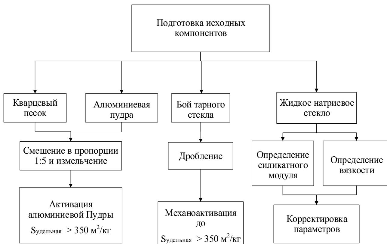
Рисунок 5.1 – Схема предварительной подготовки компонентов композита
