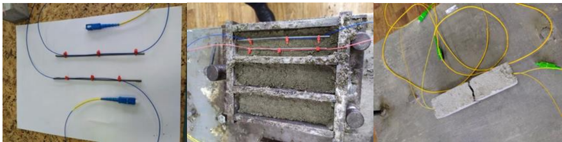
Рисунок 3.3 - Процесс подготовки балочек
