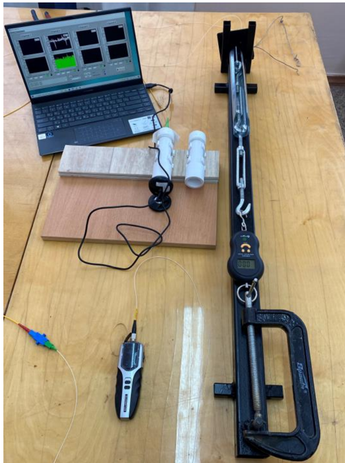
Рисунок 4.23 - Лабораторный образец волоконно-оптического датчика
