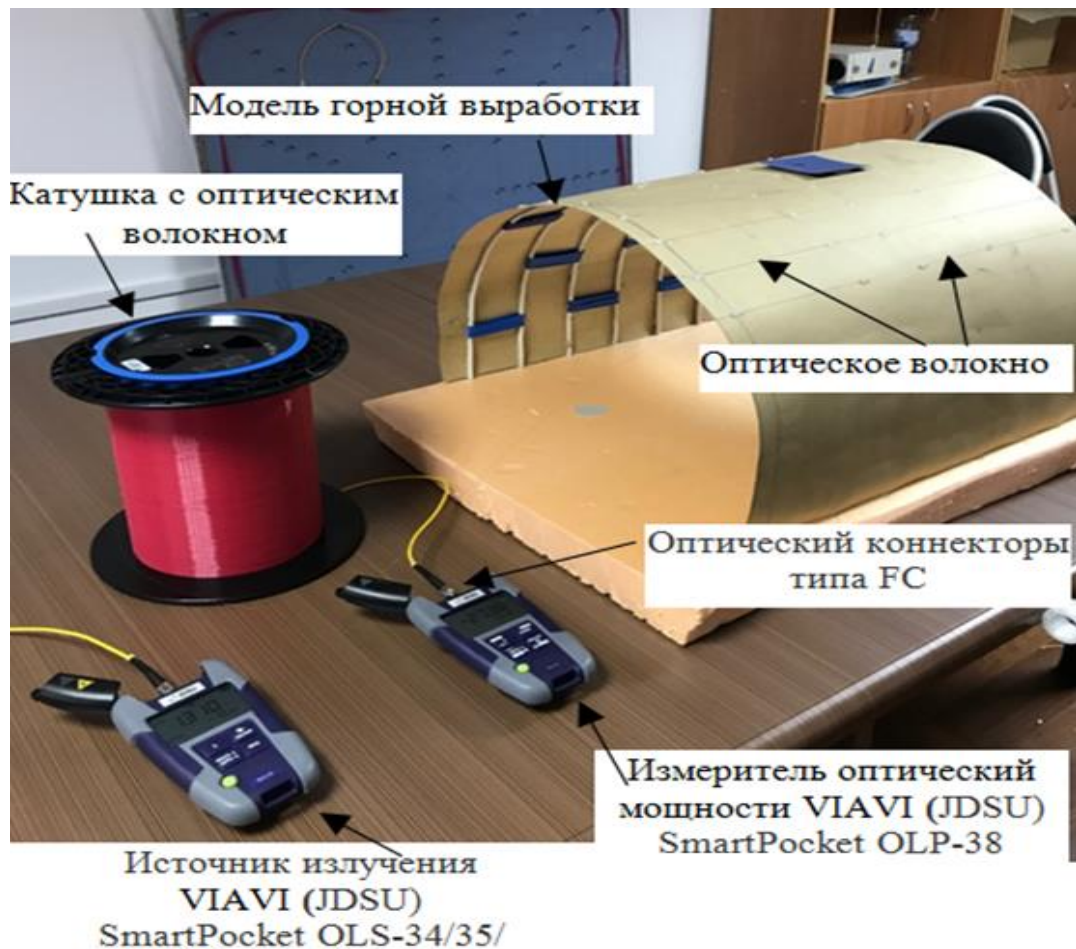
Рисунок 3.14 – Натурная модель с ВОД на основе оптических волокон G.652.D
