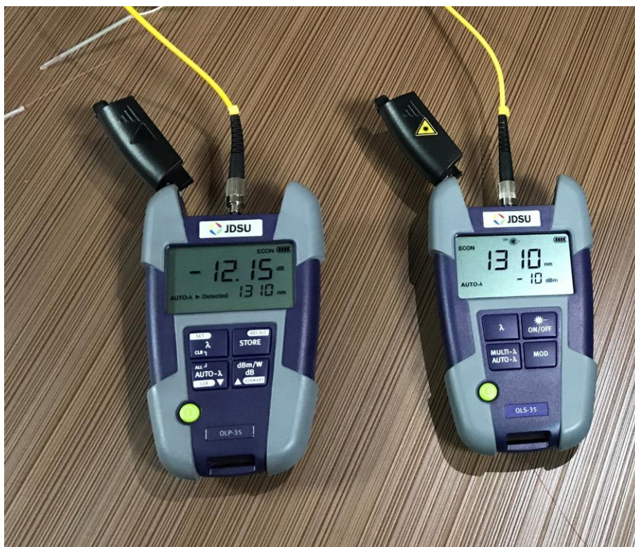
Рисунок 3.7 – Измеритель мощности оптического излучения SmartPocket OLP-38 и источник оптического излучения SmartPocket OLP-38
