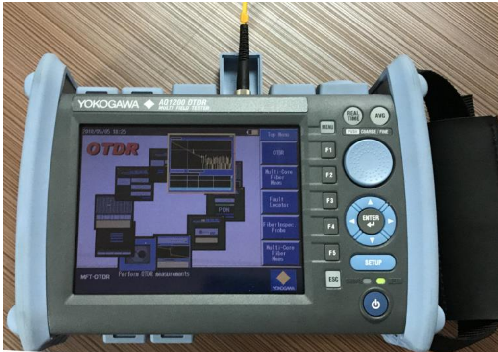
Рисунок 3.20 - Внешний вид рефлектометра YOKOGAWA AQ1200 OTDR
