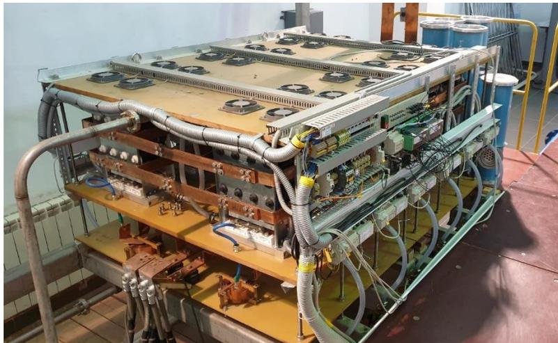
Рисунок 2.10 – Фото инвертора ИП обмотки НФС
