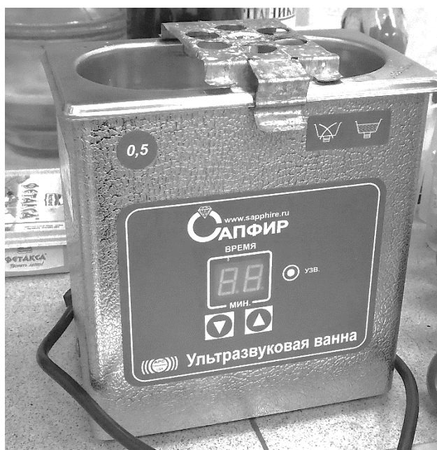
Рисунок 2.13 – Ультразвуковая ванная «Сапфир»
