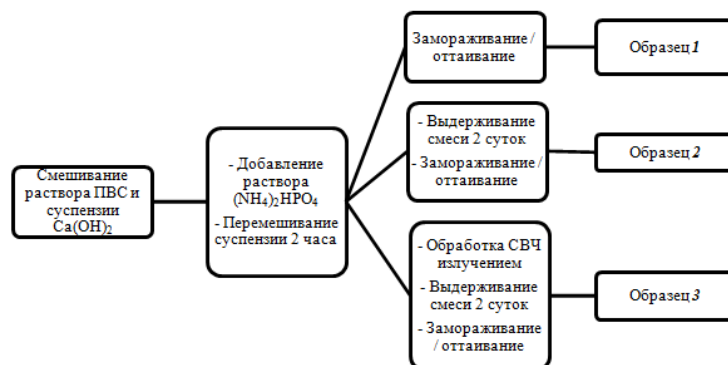
Рис. 1. Схема получения композиционных материалов 1-3
