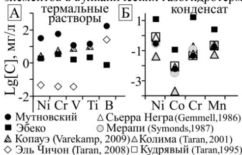
Рис. 8. Максимальные концентрации некоторых химических элементов в растворах газогидротермальных источников (А) и конденсатах парогазовой смеси серных fumarол (Б) в различных вулканических регионах.
