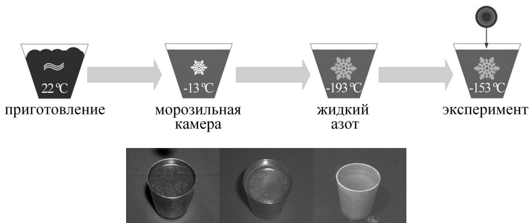
Рисунок 2.1.1. Схема подготовки и внешний вид топлива
