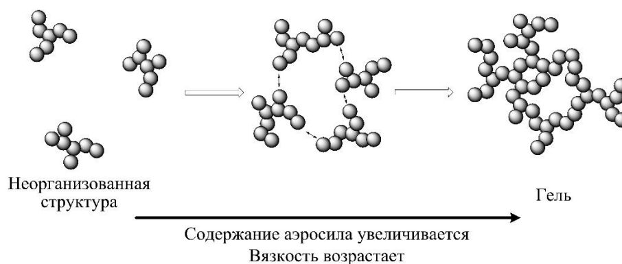
Рисунок 2.2.5. Механизм формирования геля в системе «керосин – аэросил»
