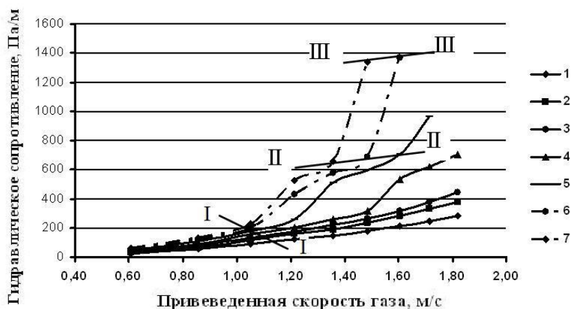
Рис. 6. Зависимость гидравлического сопротивления орошаемой насадки из цепей (модификация 1) от приведенной скорости газа
