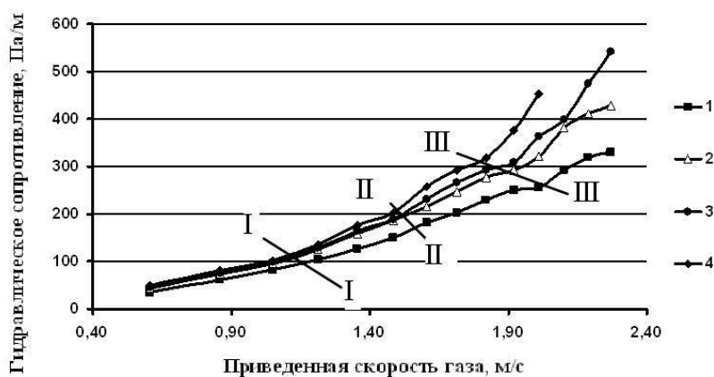
Рис. 9. Зависимость гидравлического сопротивления рулонированной сетки от приведенной скорости газа
