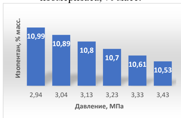
Рисунок 9. Содержание изо-пентана в изомеризате в зависимости от давления процесса изомеризации
