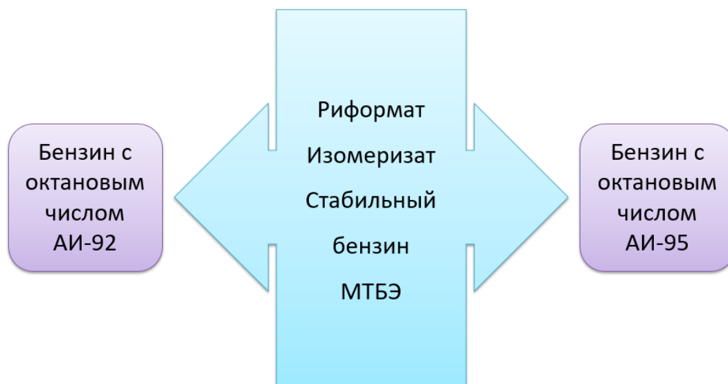
Рисунок 3. Блок-схема компаундирования бензинов
