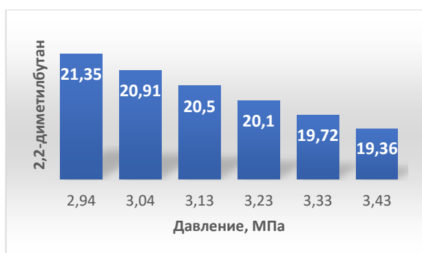
Рисунок 8. Зависимость ОЧИ изомеризата от давления, МПа
