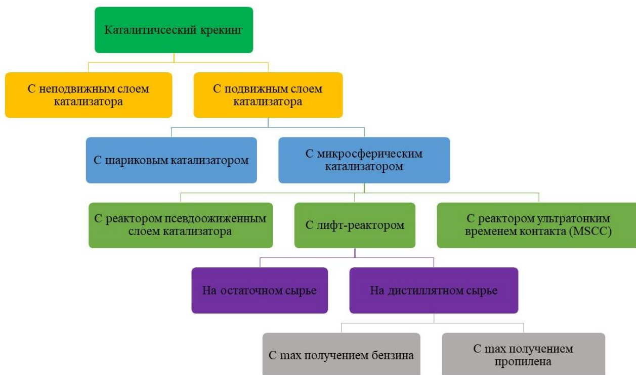
Рисунок 1.12 – Типы установок процесса каталитического крекинга
