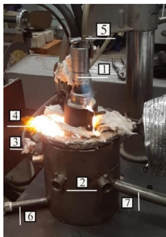
Рис. 2. Фотография плазмохимического реактора: 1 – плазматрон; 2 – реактор; 3 – трубопровод подачи азота в реактор; 4 – плазменная струя; 5 – трубопровод подачи азота в реактор в плазматрон; 6 и 7 – патрубки для водяного охлаждения реактора
