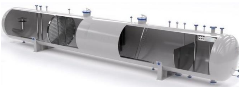
Рис. 2. Внешний вид и схема трехфазного сепаратора [19]
