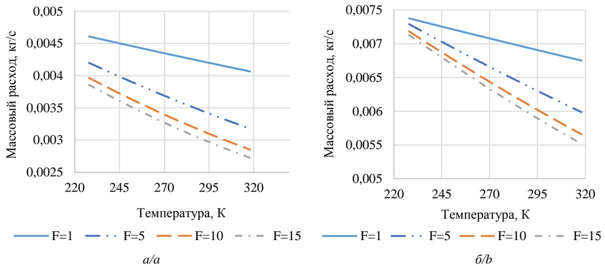
**Рис. 6.** Зависимость массового расхода газа от температуры окружающей среды при различных соотношениях  $F$  (площади радиатора к площади цилиндра) и давлении на приеме равном 1000000 (а) и 1500000 (б)
