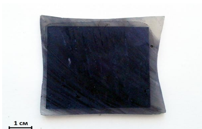
Рисунок 4.3 – Образец в виде пластины для измерения диэлектрических свойств
