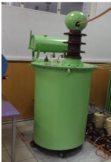
Рисунок 4.20 – Повышающий трансформатор ИОМ-100/100
