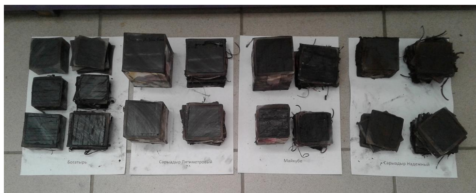
Рисунок 4.4 – Различные образцы в виде пластины для измерения диэлектрических свойств
