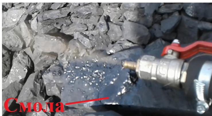
Рисунок 5.33— Смола, вытекающая из сбросного штуцера
