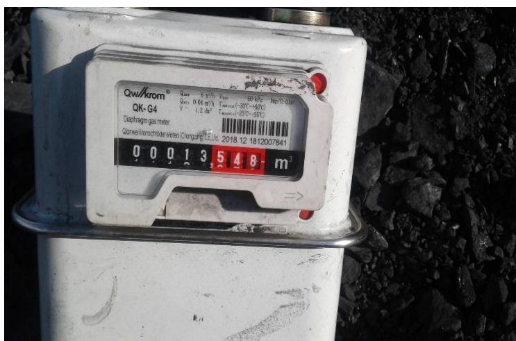
Рисунок 5.30 – Газовый счетчик G4, использованный в эксперименте
