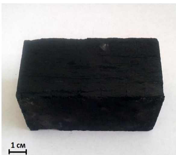
Рисунок 4.1 – Изготовленный образец для измерения диэлектрических свойств брусок из угля
