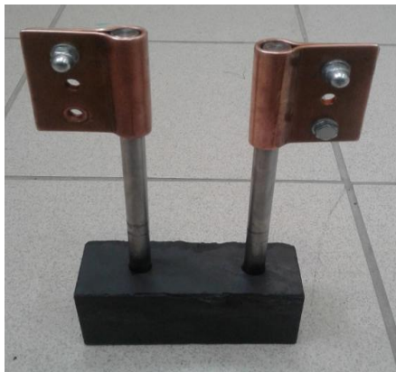
Рисунок 4.14 – Образец угля с установленными электродами для измерения характеристик ЧР
