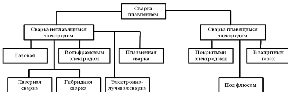
Рис. 1. Способы сварки плавлением тонколистового металла
