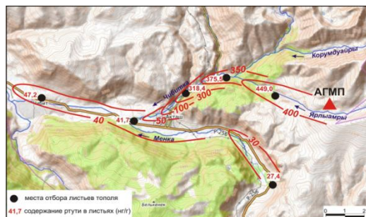
Рисунок 4 – Биогеохимический поток ртути в районе Акташского горно-металлургического предприятия по данным опробования сухой массы листьев тополя (нг/г).
