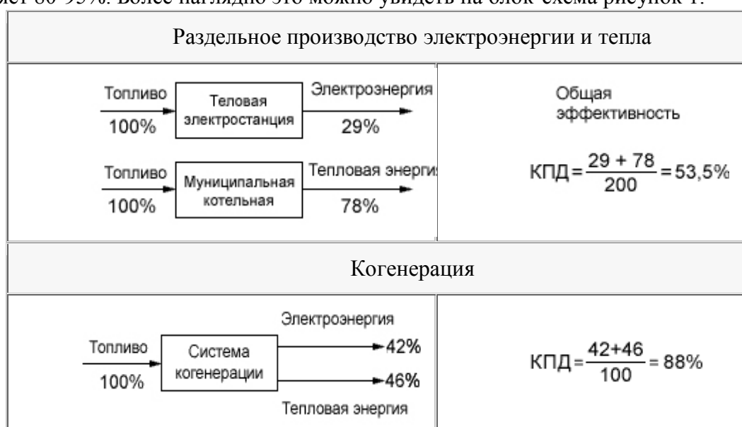
Рисунок 1. Блок-схема раздельного и совместного производства электроэнергии и тепла
