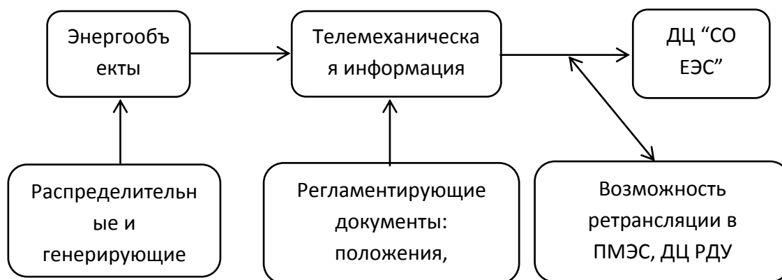
Рис.1. Принципиальная схема поступления ТМИ в ДЦ СОЕЭС.
