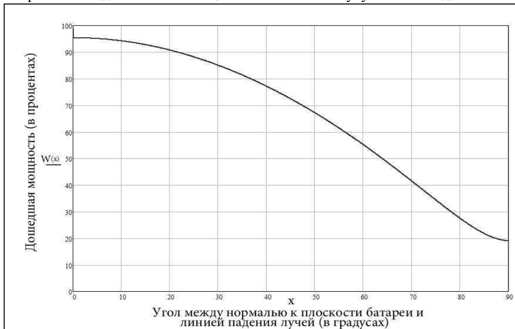
Рис. 1 Зависимость мощности батареи от угла падения на неё лучей
