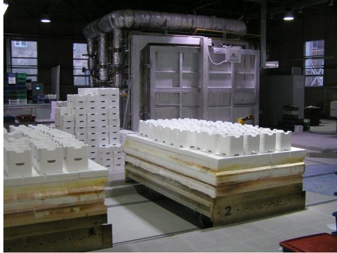
Рисунок 7– Камерная высокотемпературная газовая печь (Ried Hammer, Германия)
