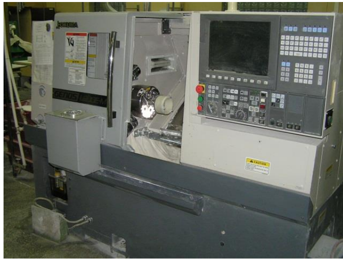
Рисунок 5. – Станок токарный с ЧПУ (Окита, Япония)
