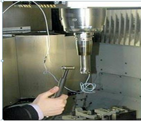
Рисунок 1.23 – Импульсное воздействие на элементы ТС для определения собственных частот объекта
