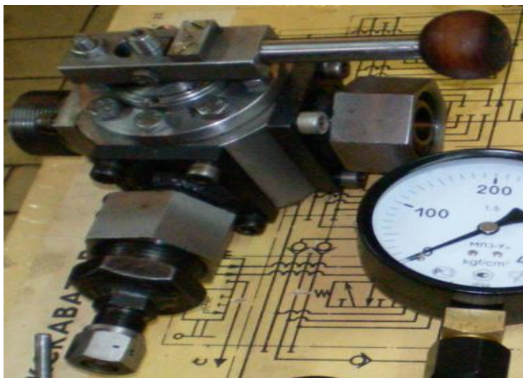
Рисунок 2.12 – Устройство для подсоединения диагностического оборудования и перераспределения потоков при диагностировании гидросистем
