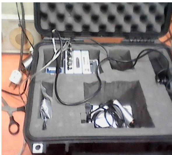
Рисунок 2.8. – Вибродиагностический комплекс К-5101
