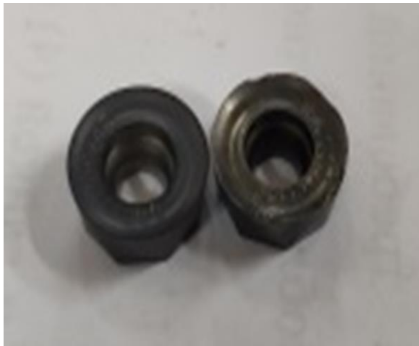
Рисунок 1.2 – а) износ и выкрашивание режущих кромок инструмента; б) разрушение режущих кромок инструмента
