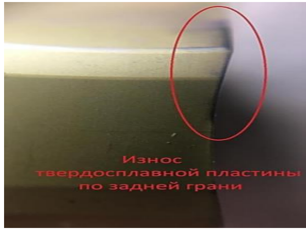
Рисунок. 4.17 – Износ твердосплавной пластины после предварительного эксперимента
