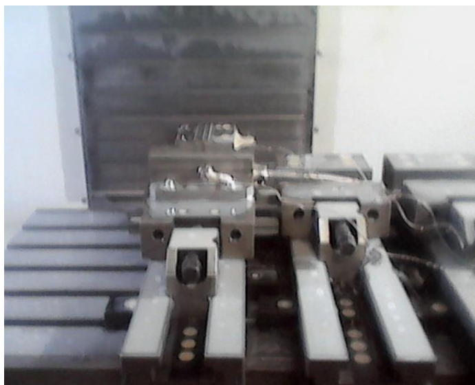
Рисунок 2.9 – Крепление динамометра Kistler на столе фрезерного станка DMO-50
