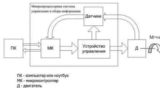
Рис. 1. Схема подключения прибора-идентификатора
