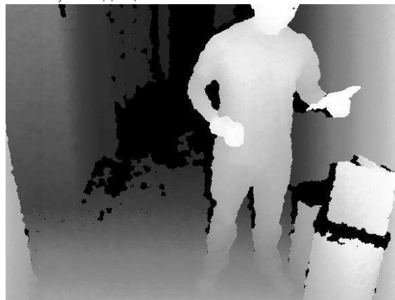
Рис. 2. Пример изображения полученного с сенсора Kinect
