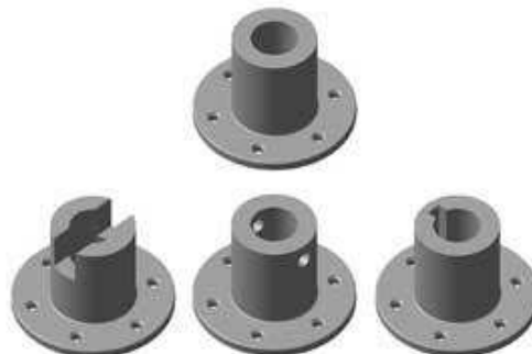
Рис. 3. Заготовка полумуфты и использующие ее детали в разных исполнениях
