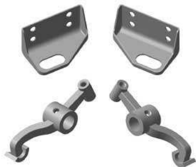
Рис. 4. Пары зеркально-симметричных деталей (опоры и коромысла)
