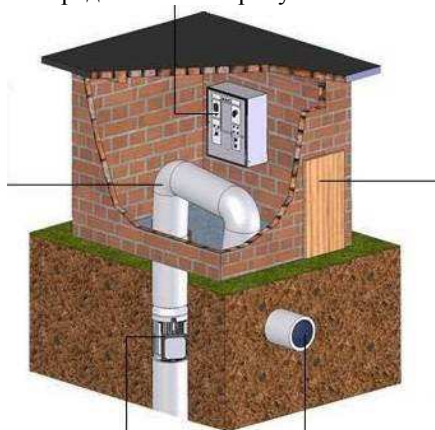
Рис. 1 Автоматизированная насосная станция
