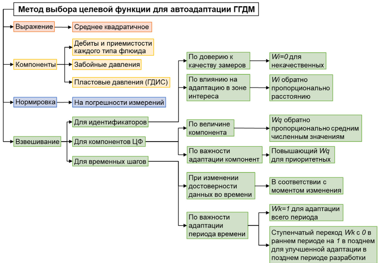
Рисунок 3.27 – Схема метода выбора наиболее эффективного вида целевой функции для автоадаптации геолого-гидродинамической модели
