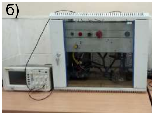
Рисунок 1 – Упрощенная принципиальная схема (а) и фотография (б) собранного электродугового реактора постоянного тока: управляемый источник питания (1), сеть 220 В (2), анод (3), катод (4), автоматизированная система перемещения анода (5), шаговый двигатель (6), драйвер (7), контроллер (8), источник постоянного напряжения 12 В (9), цифровой осциллограф (10), источник постоянного напряжения (11), высокотемпературный пирометр (12), фотокамера с нейтральным светофильтром (13)
