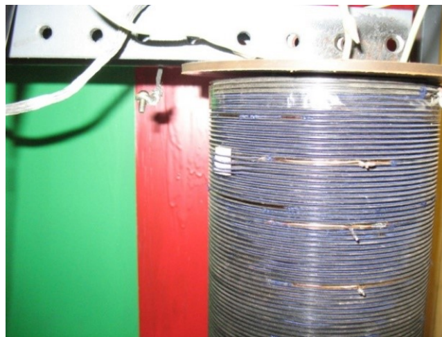
Рис. 2.26 – Смоделированный дефект «радиальное смещение витков»
