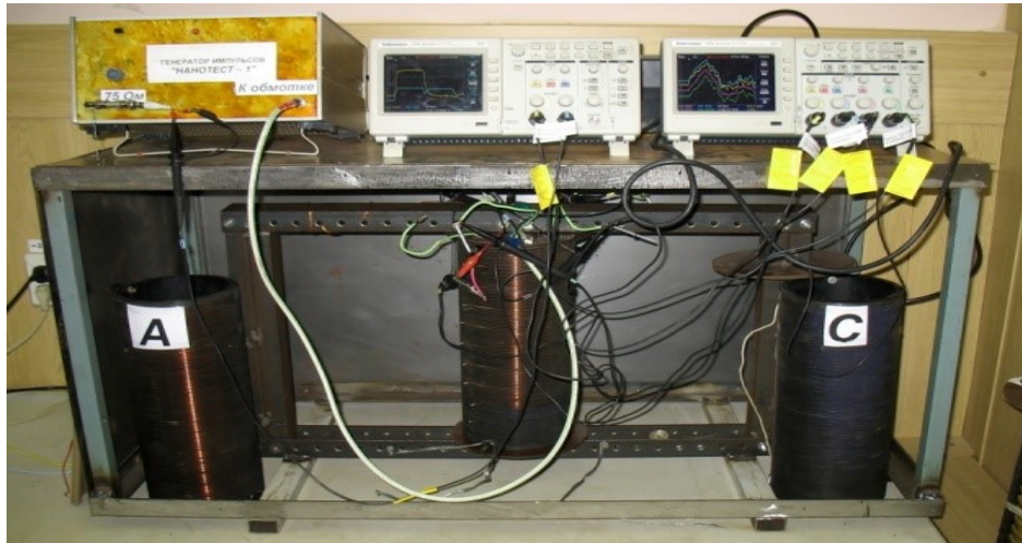
Рисунок 2.1 Внешний вид физической модели силового трансформатора
