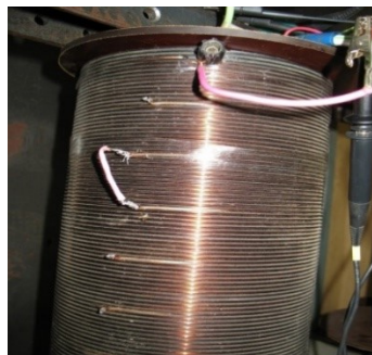
Рисунок 2.23 – Обмотка ВН: режим КЗ смоделирован в верхней части обмотки
