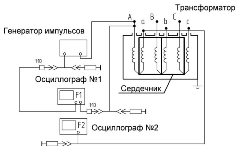
Рисунок 2.13 – Схема эксперимента по определению импульсов-откликов (осциллограф №2) при зондировании наносекундными импульсами от генератора импульсов (осциллографом №1 регистрировалось форма зондирующего импульса на обмотке)
