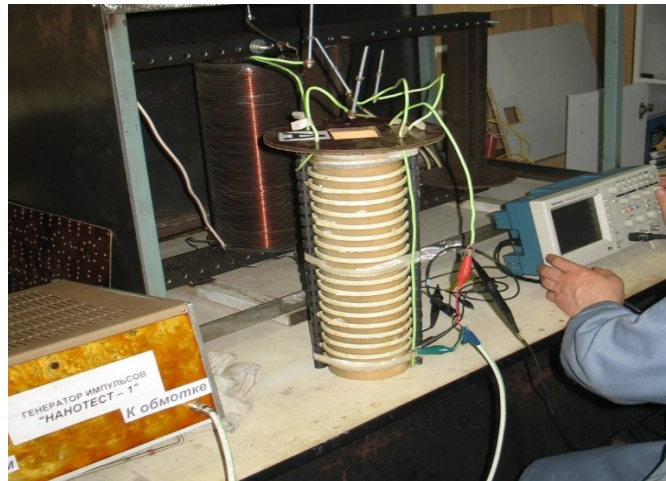
Рисунок 2.4 – Внешний вид обмотки НН физической модели, подключенной к генератору и осциллографу
