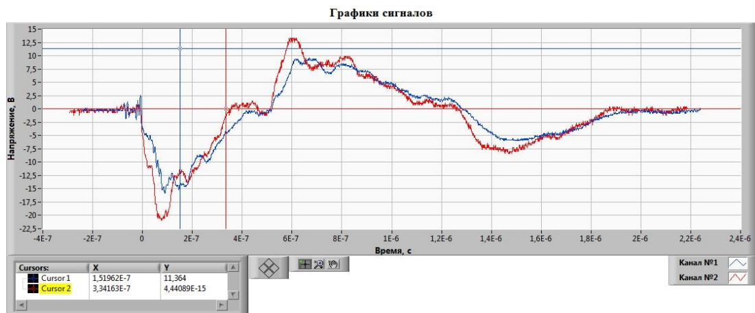
Рисунок 4.9 – Зондирующий импульс подается на обмотку фазы "А", сигнал отклика регистрируется на фазе "а"
