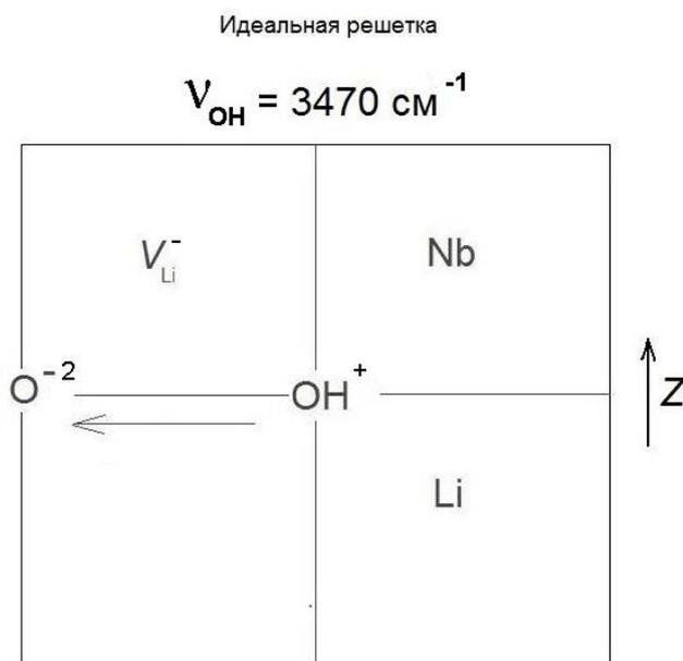
Рис. 3.3 Модель протонсодержащего центра
