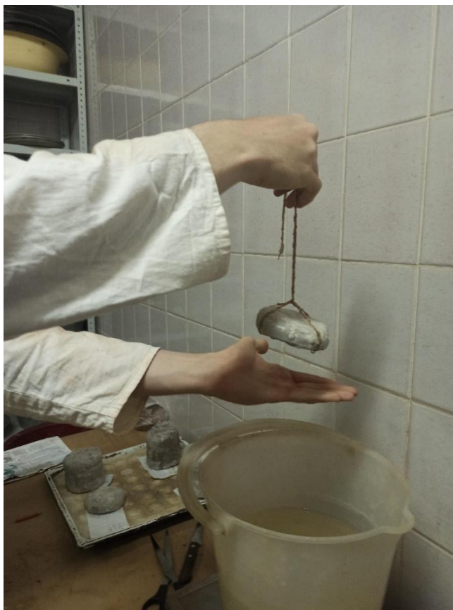
Рисунок 3.9 – Фото взвешивания парафинированного образца (автор: Спиридонова И.А.)
