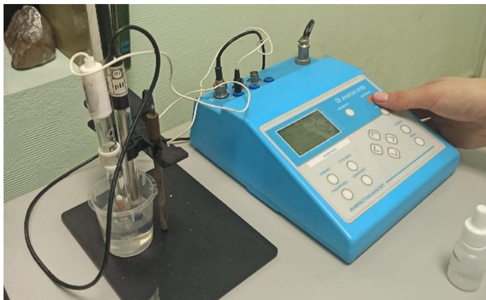
Рисунок 3.14 – Фото определение водородного показателя (автор: Спиридонова И.А.)
