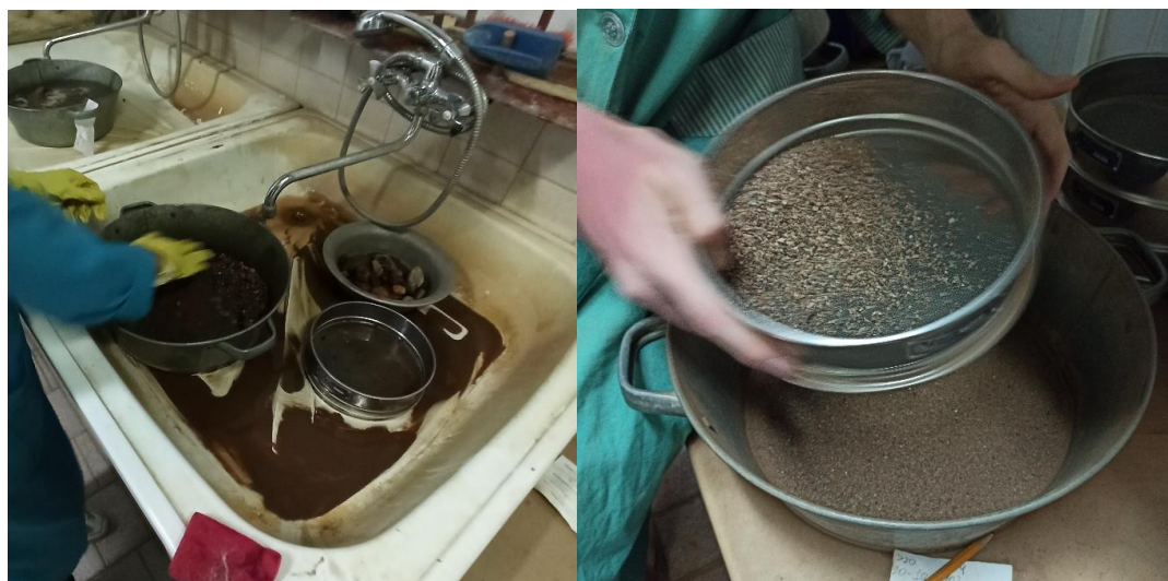
Рисунок 3.5 – Фото процесса определения гранулометрического состава
