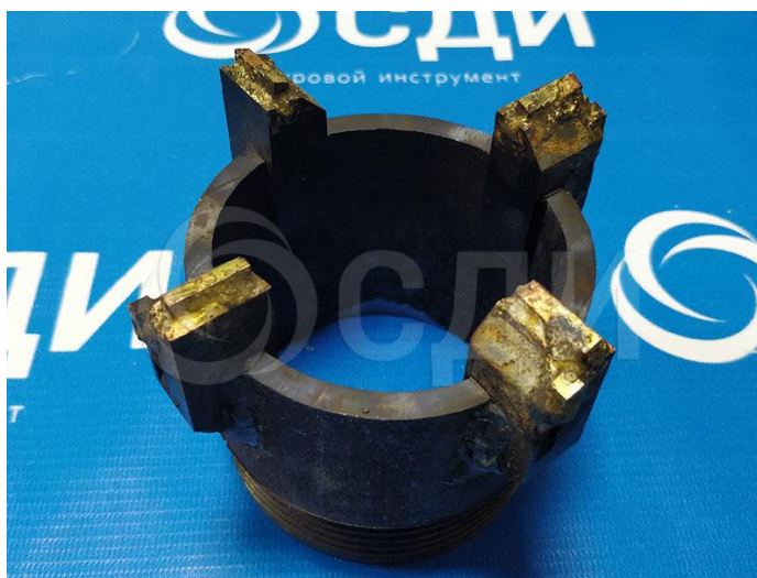
Рисунок 3.4 – Коронка тип М5 [68]
