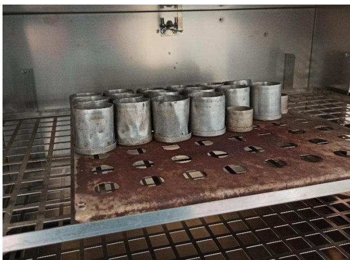
Рисунок 3.6 – Фото высушивания грунта до постоянной массы в сушильном шкафу (автор: Спиридонова И.А.)
