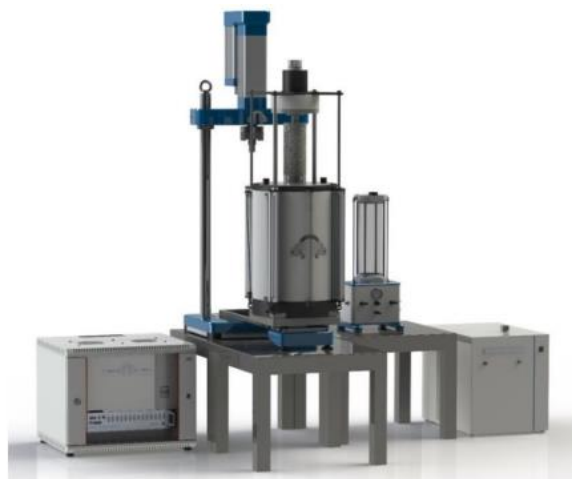
Рисунок 3.9. Автоматизированный испытательный комплекс АСИС с комплектом оборудования для испытаний образцов мерзлых грунтов методом одноосного сжатия
