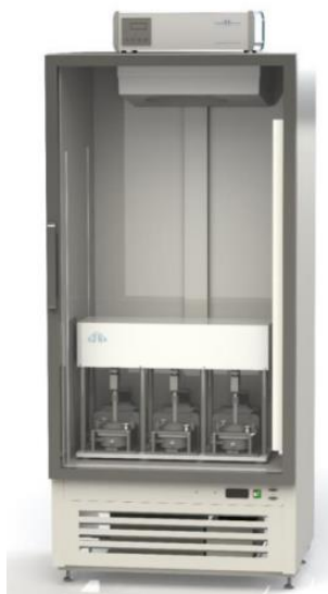
Рисунок 3.8. Прибор одноплоскостного среза для испытания мерзлых грунтов автоматизированный ГТ 1.2.14
