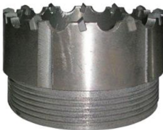
Рисунок 3. Буровая коронка с твердосплавными сменными резцами для колонкового бурения СМ-5 [7].
