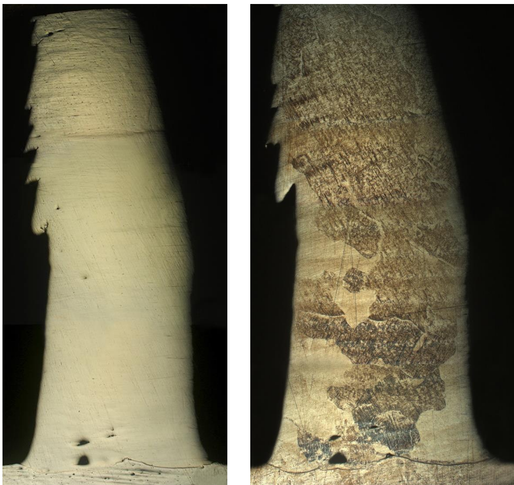
Рисунок 2.10 – Общий вид второго образца а) после полировки б) после травления
