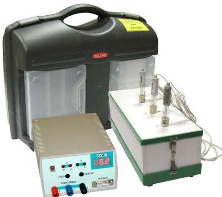
Рисунок 3.8 – Анализатор коррозионной активности грунта АКАГ
