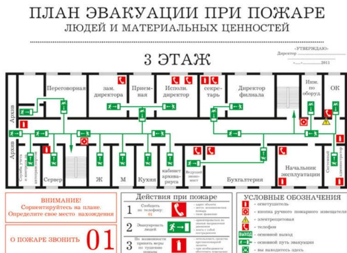
Рисунок 4.2 – План эвакуации
