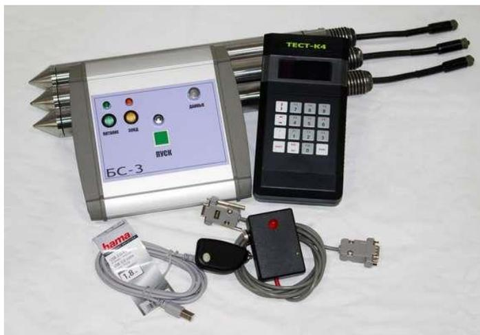
Рисунок 3.3 – Комплект ТЕСТ-К4М конструкции АО «Геотест» [49]
