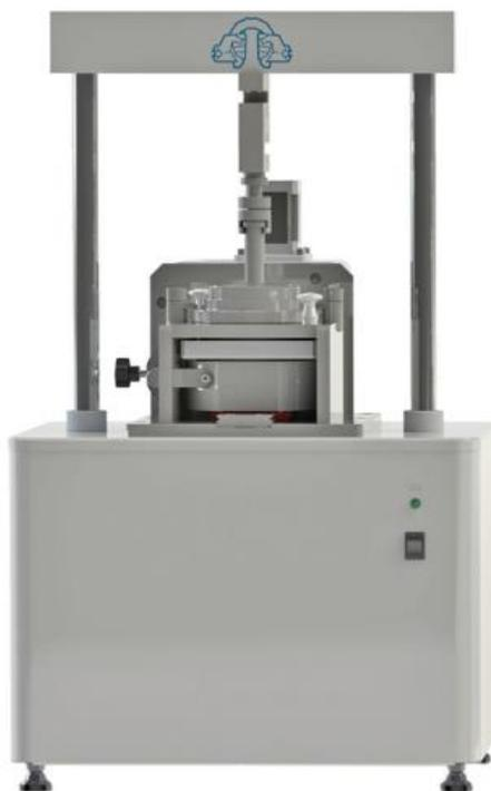
Рисунок 3.7 – Прибор одноплоскостного среза серии Стандарт ГТ 1.2.11
