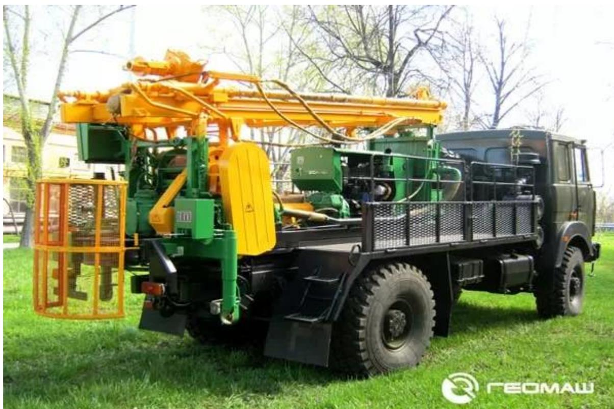
Рисунок 3.2 – Буровая установка ПБУ-2 [55]
