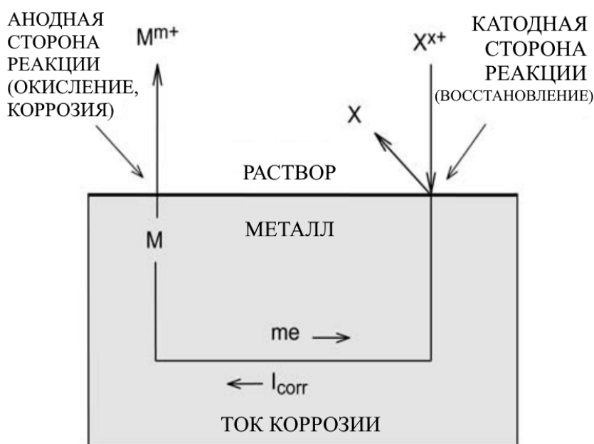
Рисунок 4.4 – Основной процесс коррозии
