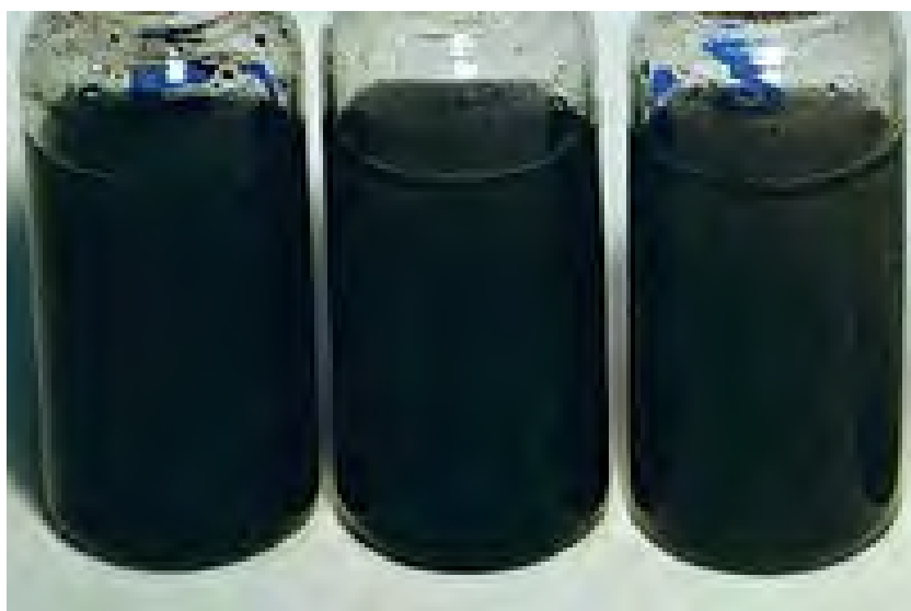
Рисунок 2.4 – Рост сульфатвосстанавливающих бактерий с образованием осадка сульфата железа
