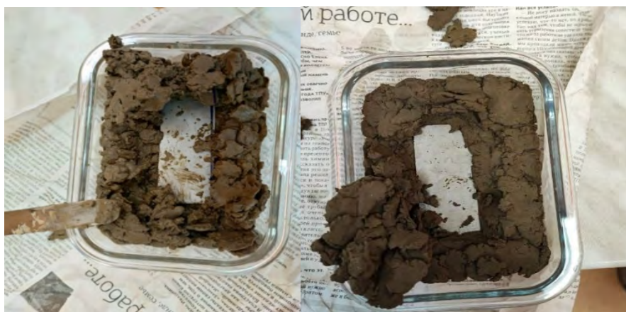
Рисунок 2.5 – Стальная пластинка в грунте для определения биокоррозии (эксперимент автора)
