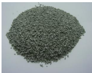
Рисунок 14 – Продукт дробления железосодержащего композита на силиконовой матрице с размером 0,63–2,5 мм.
