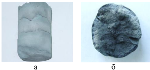
Рисунок 3 – Фотографии продукта горения ферросиликоалюминия в азоте (а) и поперечного разреза этого образца (б), P_{N_2} = 4\text{МПа} , d = 40\text{ мм} .
