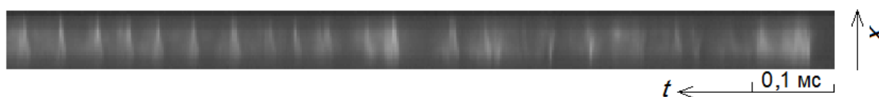
Рисунок 9. x, t – диаграмма детонационных волн
