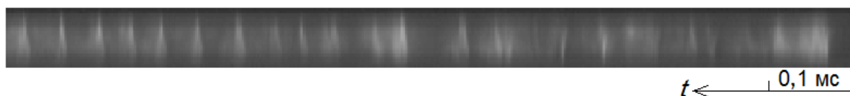
Рисунок 38. x, t – диаграмма, отображающая переход режима с НМД в НСД: g_{\Sigma} = 114 \text{ кг}/(\text{с}\cdot\text{м}^2) , \phi = 0,99 ; НМД – f = 13,8 \text{ кГц} ; НСД – f = 24,9 \text{ кГц} , n = 4 , D = 1,96 \text{ км}/\text{с}
