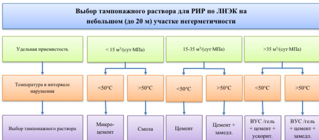
Рисунок 24 – Алгоритм выбора тампонажного состава для ремонтно-изоляционных работы
