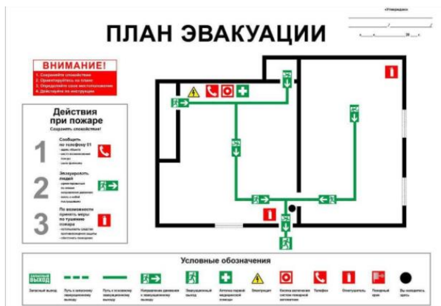
Рисунок 42. План эвакуации, составленный по ГОСТ 12.1.004-91 ССБТ "Пожарная безопасность. Общие требования"
